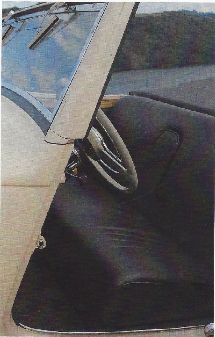
Lorsqu'il a été retrouvé, ce cabriolet comportait une sellerie verte avec capote noire munie de trappes en plexiglas. Elle a été remplacée par une capote marron et sellerie cuir assorti qui s'harmonise avec la teinte beige de la carrosserie. Petite concession au confort : Gilles Bercet a opté pour un accoudoir central et une banquette relevable.
