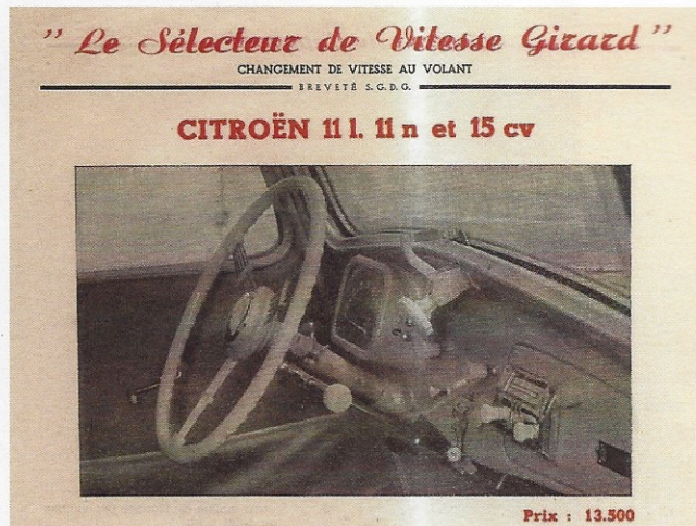
Rare document présentant la notice du Sélecteur Girard avec sa fixation sur la colonne de direction et ses biellettes de renvoi. L'absence d'embouti pour le sélecteur d'origine laisse supposer un montage de tableau de bord hors série (fourni avant finition par Citroën ?) ou artisanal.
