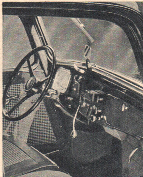
Oben: Armaturenbrett des Citroën „11“. Beachtenswert ist die typische Citroënschaltung und das praktische Einblick-Instrument.
