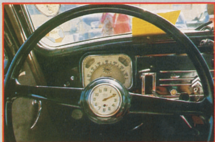
Cette montre mécanique s'adaptait à la place de l'enjoliveur central de volant.
