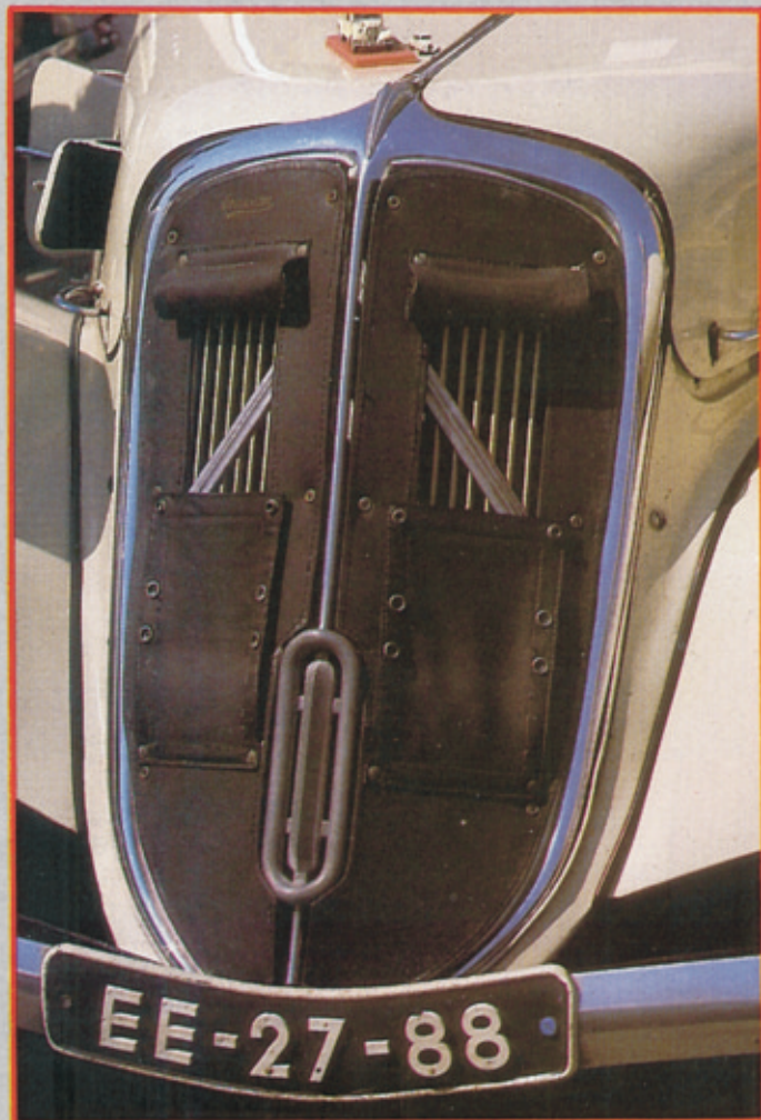
Le tablier pour calandre de Traction tous modèles permettait au moteur de prendre sa température de fonctionnement l'hiver.
