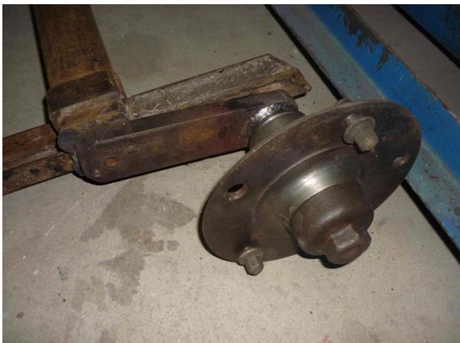
La remorque d'Eddy est très semblable à la mienne avec son essieu à suspension par silent-blocs et roues indépendantes. Il a également réalisé la transformation de l'essieu, afin de permettre le montage de roues de Traction à 5 tocs.
